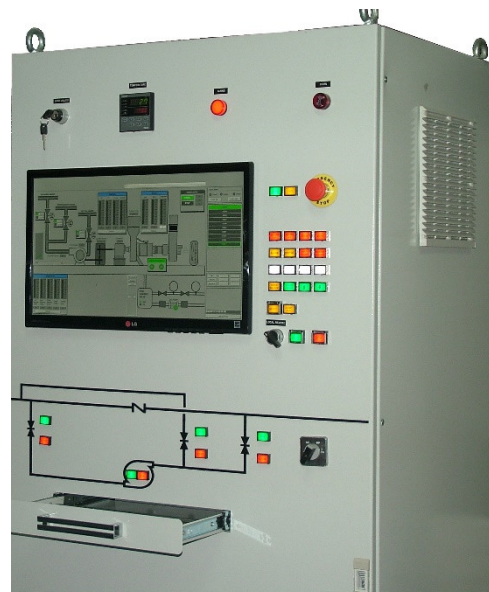
نمای داخلی تابلوی کنترل توربین سولار سنتر با استفاده از PLC500 Nseries ساخت کنترلیک
